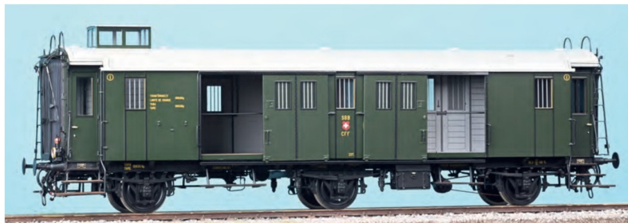
Der F3ü 18262 mit zusätzlichem Oberlicht für den Einsatz auf den Strecken der französischen PLM.
