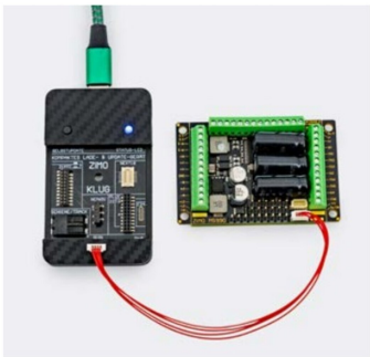
ZIMO-Grossbahndecoder können zum Programmieren via SUSI angeschlossen werden.
