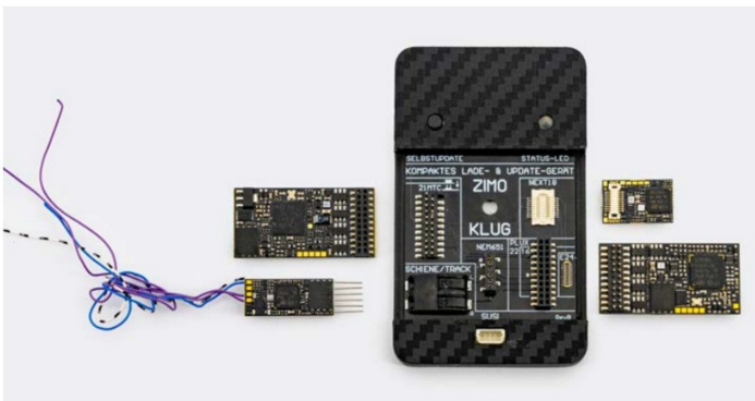
Decoder mit 21MTC-, PluX22/16/12-, Next18- und NEM-651-Schnittstelle können eingesteckt werden.
