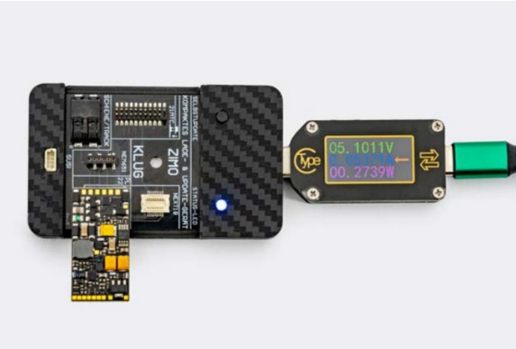
Das KLUG benötigt kein separates Netzteil, sondern wird direkt über den USB-Anschluss mit Strom versorgt.
