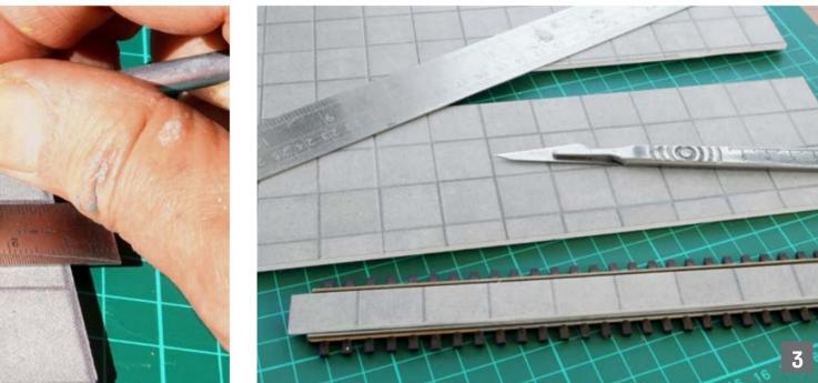
**Bild 2** Da es sich um Schaumstoffplatten handelt, bleiben Eindrücke erhalten. So lassen sich beispielsweise mit einem Tonmesser aus Metall gut Vertiefungen in die Oberfläche prägen, welche die schmalen Fugen zwischen den Platten darstellen; eine weitere Möglichkeit wäre ein Holzstab. Beide müssen an einem Stahllineal geführt werden. Bastelmesser eignen sich nicht für dieses Material, da sie es einfach durchschneiden.
