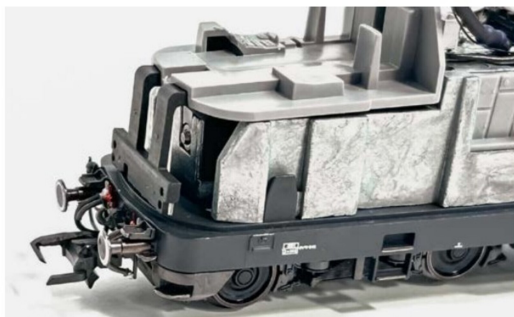
Die Halterungen der Beleuchtung passen exakt in die alten Führungen.
