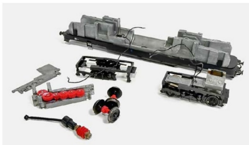
Gereinigt und geschmiert warten Antrieb und Achsen auf den Einbau.
