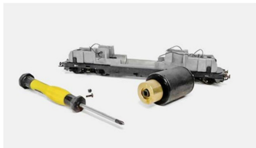
Der alte Motor wird ausgebaut und später nicht mehr wiederverwendet.
