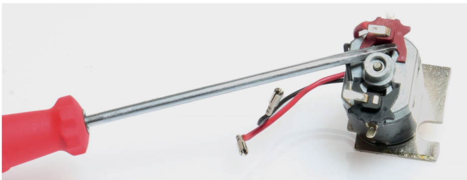
Zum Abziehen der Kontakte können die beiden Kunststoffplättchen vorsichtig mit einem kleinen Schraubendreher herausgedrückt werden.
