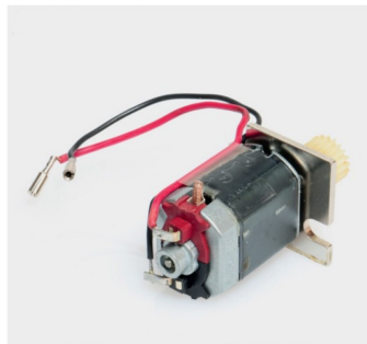
Beim Öffnen der Lasche ist darauf zu achten, dass Feder und Kohle nicht davonspicken.
