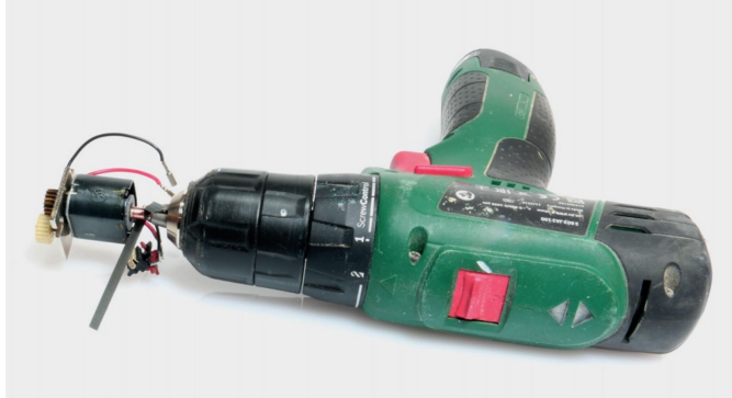
Wer keine Drehbank hat, kann die Motorwelle in eine kleine Handbohrmaschine einspannen.
