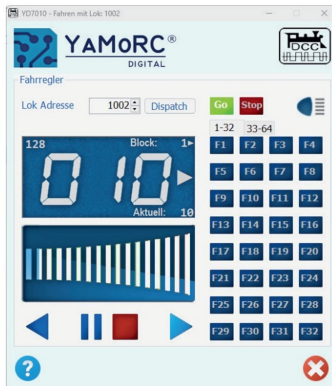
Im Softwarefahrregler der Zentrale werden RailCom-Nachrichten des Decoders angezeigt.
