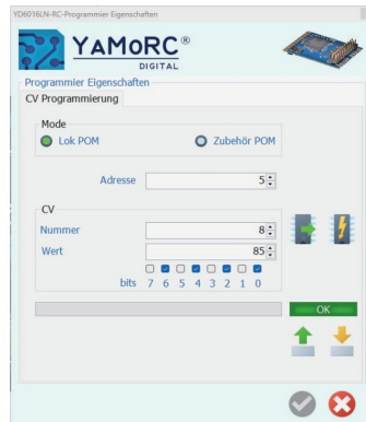
Mit dem Rückmelder lassen sich auch CVs im laufenden Betrieb auf dem Hauptgleis auslesen.
