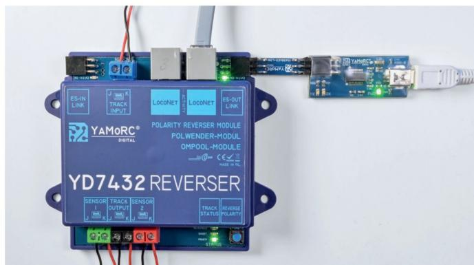
Einstellungen des YD7432 werden über ES-Link am PC vorgenommen. Dank LocoNet-Anbindung werden die erfassten RailCom-Meldungen im Kehrschleifenabschnitt im PC-Programm angezeigt.
