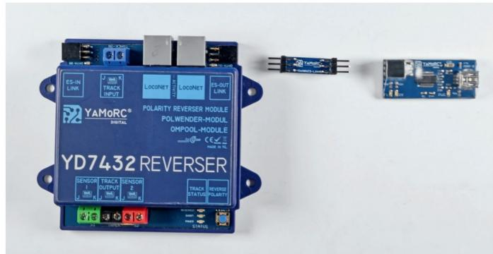
Auch die Konfiguration des Kehrschleifenmoduls von YaMoRC erfolgt mittels Windows-Software. Dies geschieht über den ES-Link mit einem mechanischen Adapter und einem USB-Interface.
