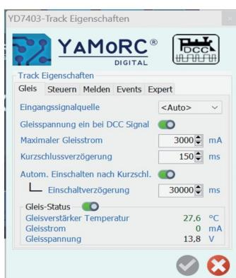
Mit dem Konfigurationsprogramm lassen sich etliche Dinge am Booster einstellen.
