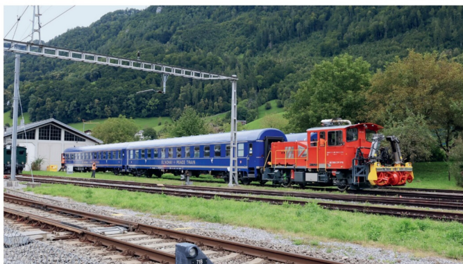
Das Rangieren der Hotelzugswagen in Glarus erfolgte mit der Schneeschleuder Xrotm 491 112.
