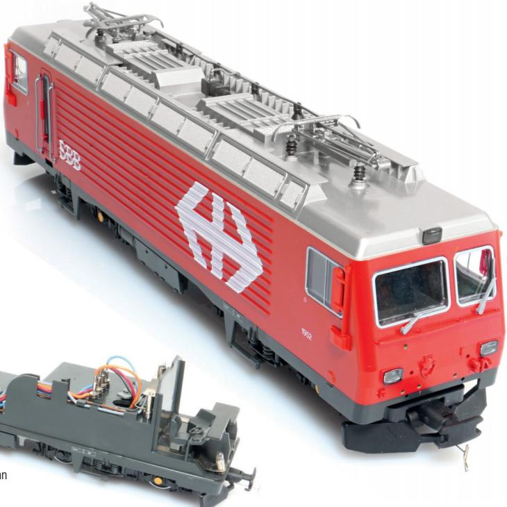
Nach dem Lösen der Schraube am Boden kann der Lokkasten abgehoben werden.
