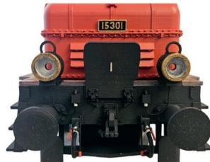
der SBB De 6/6 15301 präsentieren. Für einzelne Teile setzt der Hersteller dabei anstelle von Kunststoff auf Metall-3D-Drucktechnik. Das Modell verfügt ab Werk über einen ESU-LokSound-5-XL-Decoder und wird von zwei Antriebsblöcken auf vier Achsen angetrieben. Optional kann die Lok mit einer Pantografensteuerung und einer Rangierkupplung bestellt werden. Als Liefertermin gibt Geschäftsführer Marco Suter den kommenden Sommer an.
