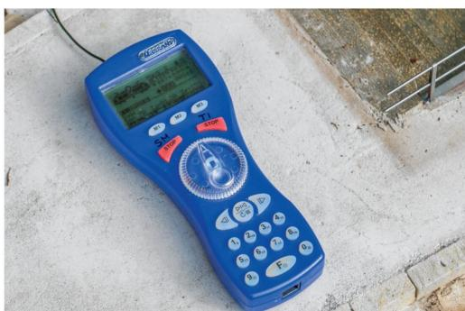
Gesteuert wird die Anlage mit den Funkhandreglern von Massoth, die Fahrtrichtungstasten wurden gleich mit den Endbahnhöfen beschriftet.
