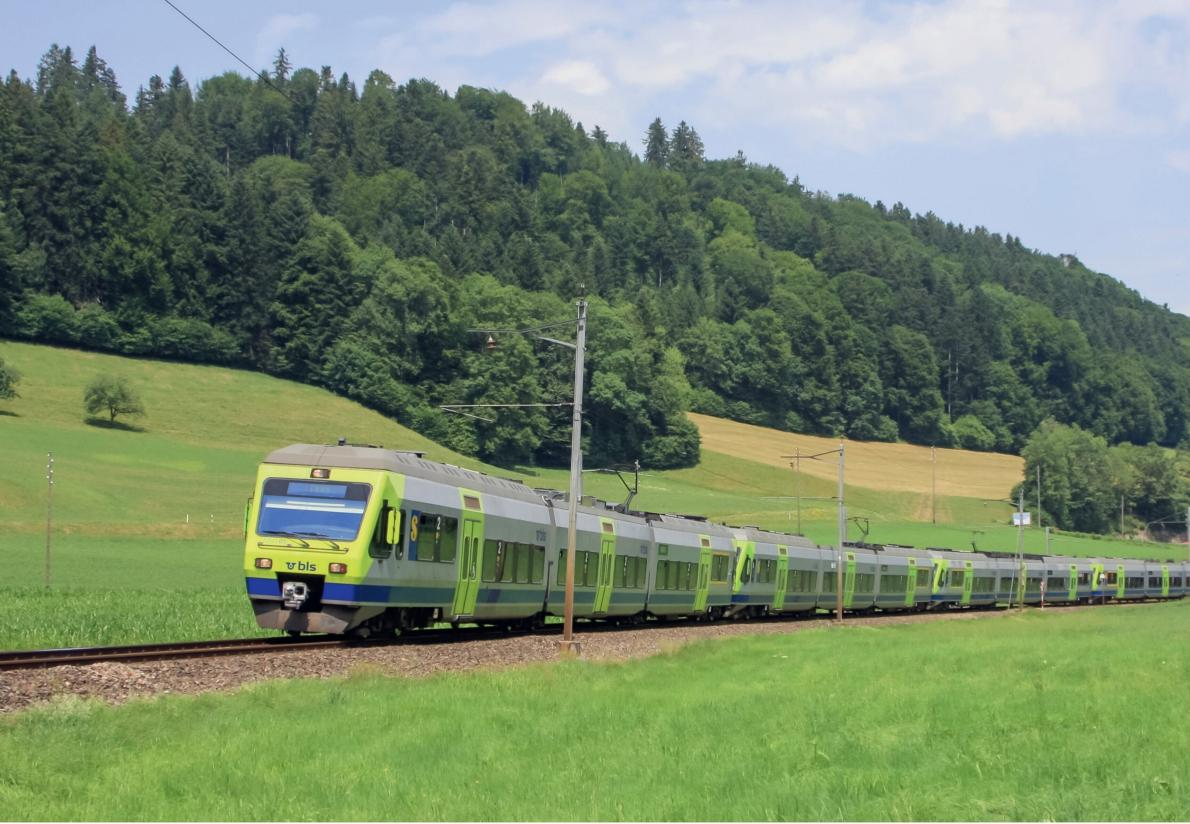
sind angetrieben. Die NINA kann mit einer Höchstgeschwindigkeit von 140 km/h verkehren. Sie verfügt über automatische Kupplungen (Scharfenberg), um flexibel auf betriebliche Bedürfnisse wie das Stärken und/oder Schwächen im Spitzentkehr zu reagieren zu können.
