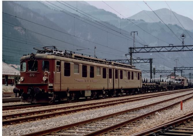
Zwischenloks waren vor allem auf den steilen Alpenstrecken im Einsatz: Eine BLS Ae 4/4<sup>II</sup> ist hier als Zwischenlok eingereiht, zugführend zieht die Ae 8/8 272.
