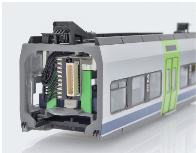
Die Verbindung der Zugsteile erfolgt über einen mehrpoligen, recht filigranen Stecker.
