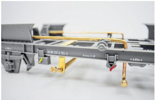
Die Leitungen für den Tank wurden aus Rundmessingrohren erstellt.
