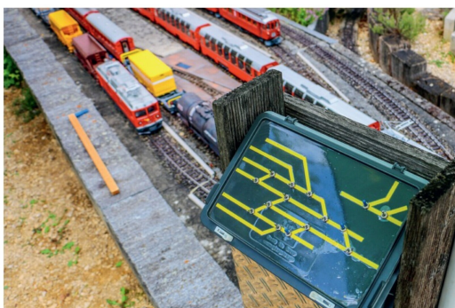
Jeder Bahnhof hat sein eigenes Stellwerk, die Weichen können mit Kippschaltern gestellt werden, was die Rangiermanöver vereinfacht.
