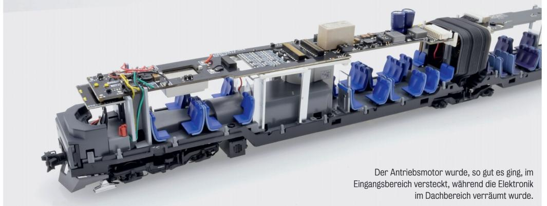
Der Antriebsmotor wurde, so gut es ging, im Eingangsbereich versteckt, während die Elektronik im Dachbereich verräumt wurde.
