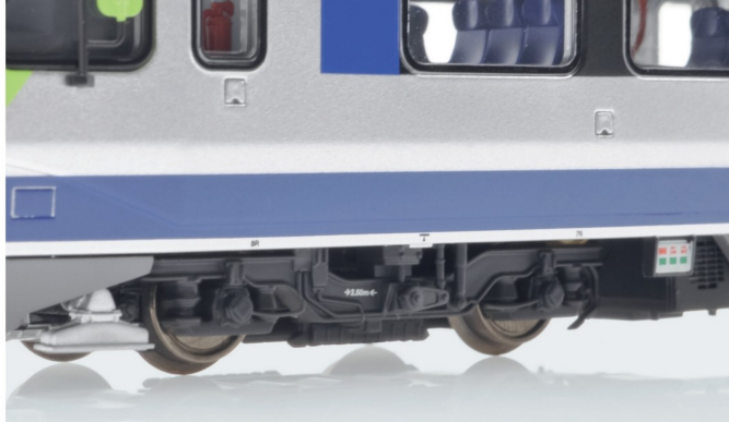
Die Enddrehgestelle sind wie beim Vorbild angetrieben und weisen zahlreiche Details auf.
