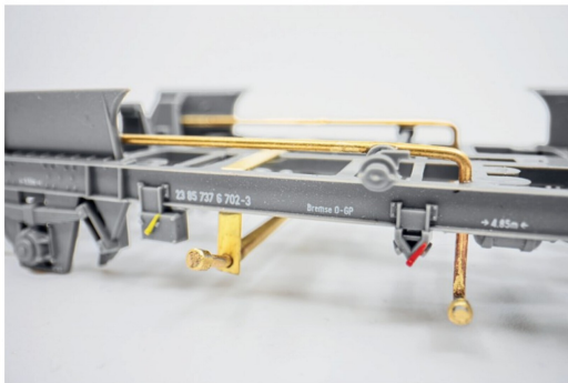
Die Leitungen für den Tank wurden aus Rundmessingrohren erstellt.
