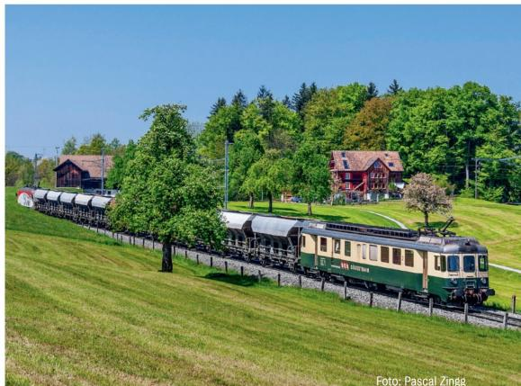
Auch bei der SOB gab es Schiebedienst: Der BDe 4/4 unterstützt am 7. Mai 2008 am Zugschluss die Re 446 bei der Beförderung des Kieszugs.
