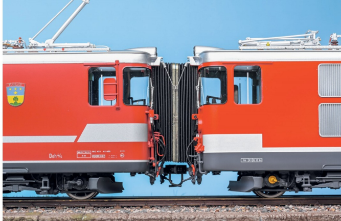
Die Faltenbälge haften magnetisch, auch mit Produkten anderer Hersteller.
