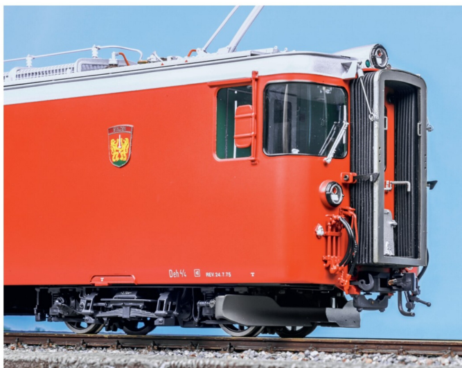
In Ruhestellung sind die Faltenbälge in der vorbildgerechten Halterung fixiert.
