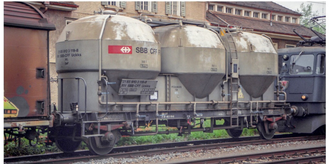
Der Uckss 21 85 910 3 119-8 war einer der drei modernisierten und mit geänderter Rohrführung versehenen Wagen. Hier eingereiht in einem Güterzug am 16. April 2024 in Gümligen.
