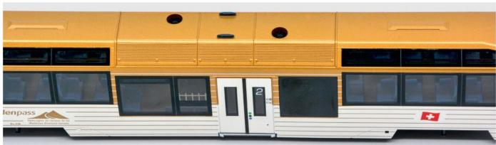
Von oben ist auf dem Dach auch die gut versteckte Klimaanlage in der Wagenmitte zu erkennen.
