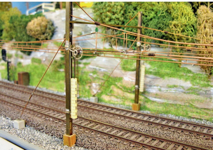
Mast und 1500-V-Oberleitung basierend auf Sommerfeld- und Eigenbauelementen.
