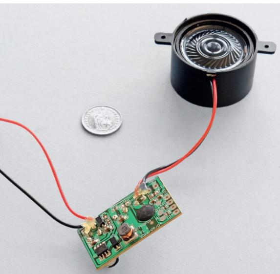
Die beiden Drähte auf der linken Seite dienen zum Anschluss an die ungesteuerte Seite eines 16-V-Wechselstrom-Gleichstrom-Transformators. Der Lautsprecher hat zwei Löcher für die beiden mitgelieferten Schrauben, mit denen er auf der Grundplatte befestigt wird.
