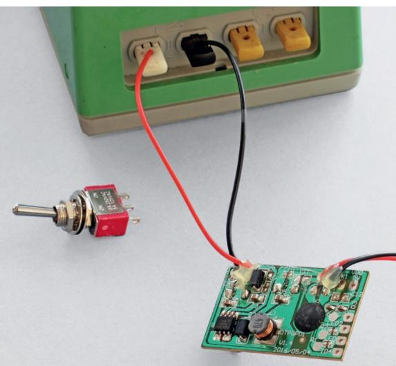
Ein Minikippschalter, der an das rote Kabel angeschlossen werden kann, um eine Ein-Aus-Verbindung herzustellen, ist im herkömmlichen Elektrofachhandel eines Baumarkts oder im Onlinehandel erhältlich. Mit dieser Funktion kann der Spielwert der Anlage gesteigert werden.
