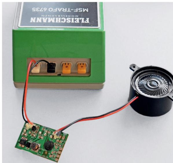
Nun sind die Anschlussdrähte an die ungesteuerte Seite eines alten Fleischmann-Transformators angeschlossen. Für den Einbau auf einer Modellanlage sind die roten und schwarzen Drähte mit 8 cm Länge sehr kurz und müssten aus diesem Grund verlängert werden.
