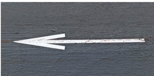
Nach dem Langzeittest weist die Markierung etwas Verschmutzung auf.
