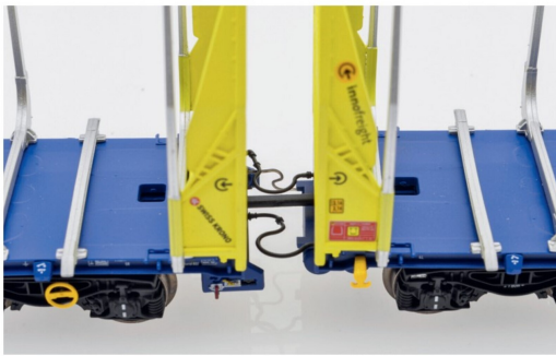
Die Wagen sind untereinander mittels einer starren Kupplung verbunden.
