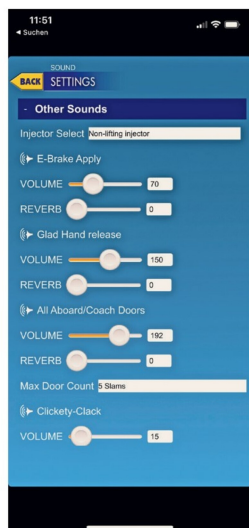
Über die Bluetooth-App kann auf alle relevanten Soundparameter direkt zugegriffen werden.
