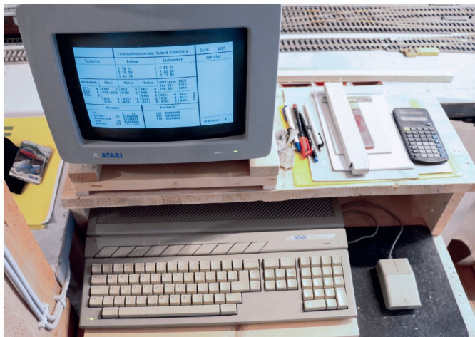
Über diesen Atari läuft die Steuerung der Anlage, auf der 45 Signale gestellt werden können.
