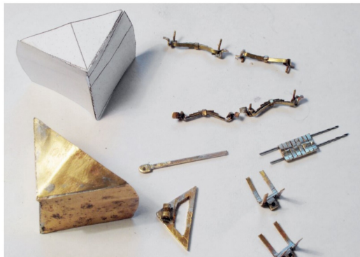
Musterpflug aus Papier, Rohbau Pflug, Stellstange Pflug, Stellstangenlager, zwei Pfluglager, Rohbau Bremsen und fertige Federpakete.
