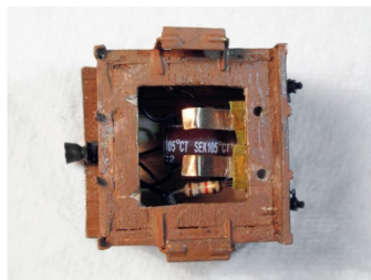
Ein Blick durch die Bodenöffnung des Aufbaus auf die bereits montierte Elektronik.
