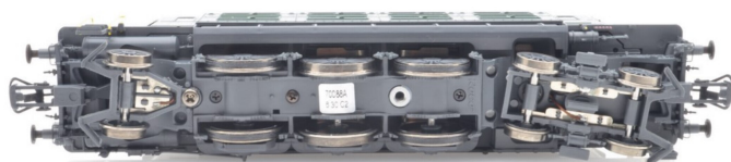
Die Stromaufnahme erfolgt über fünf der insgesamt sechs Achsen der Elektrolokomotive.
