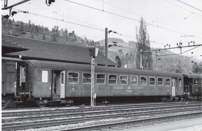
Ein Zweitklasswagen mit Übersetzfenster in der Ursprungsausführung mit Faltenbalg.
