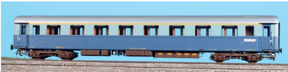
Dieser Erstklasswagen Az war seit der Einführung der «Tipo 1946» als solcher in Betrieb.
