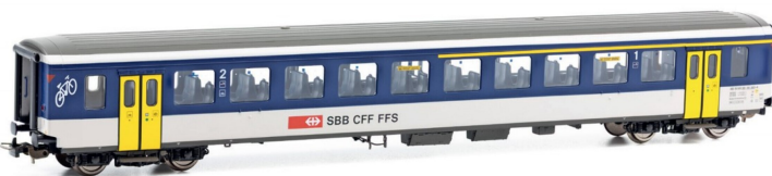
Ein EW I NPZ im letzten Betriebszustand. Schwenkschiebetüren, ein B zu einem AB umklassiert und Anstrich für den S-Bahn-Einsatz.
