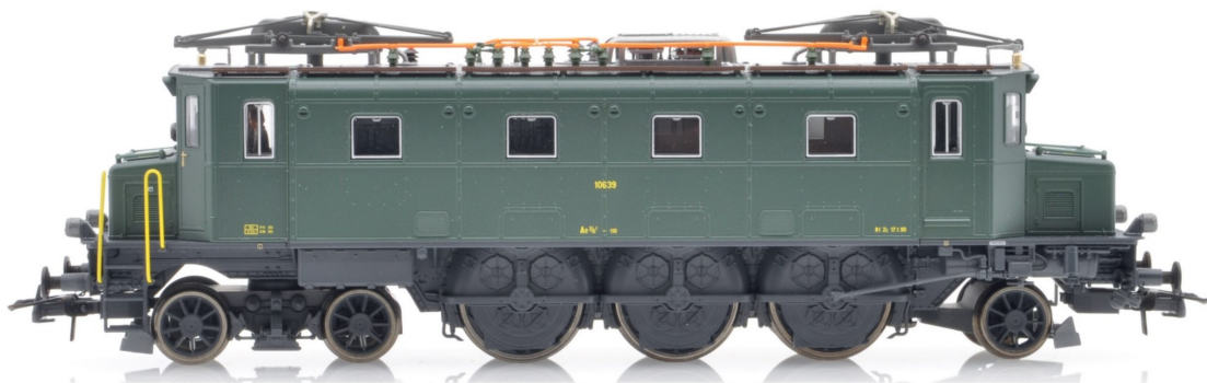
Die Seitenansicht zeigt gut den konstruktiven Knick im Rahmen über der ersten Vorlaufachse, der auch das Befahren enger Radien ermöglicht.
