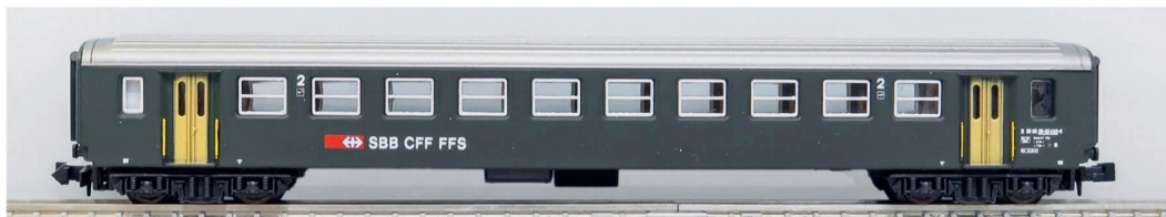
Besonders interessant ist der SBB B 50 85 20-33 433-4 mit den auffälligen Übersetzfenstern und einer Prototypbeschriftung in Hellgrau.
