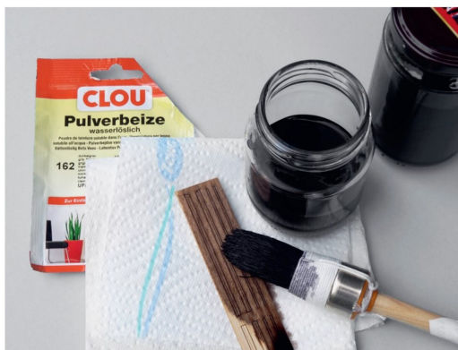
Es ergibt Sinn, das Beizen vorher an einem Reststück auszuprobieren.
