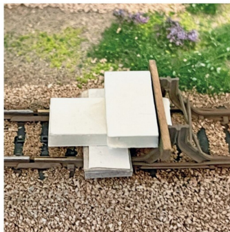
Zur Montage wird eine Lehre konstruiert, Zweikomponentenleim schafft die Verbindung.
