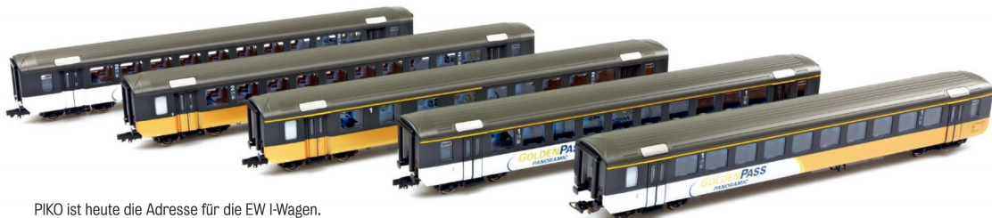
Ein EW I NPZ im letzten Betriebszustand. Schwenkschiebetüren, ein B zu einem AB umklassiert und Anstrich für den S-Bahn-Einsatz.
