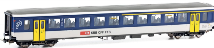
Ein EW I NPZ im letzten Betriebszustand. Schwenkschiebetüren, ein B zu einem AB umklassiert und Anstrich für den S-Bahn-Einsatz.
