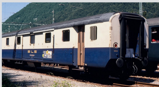
Der «EW I» D 50 63 92-33 551 der BLS, modernisiert mit Gummistübergängen, 1988 abgestellt in Interlaken Ost.
