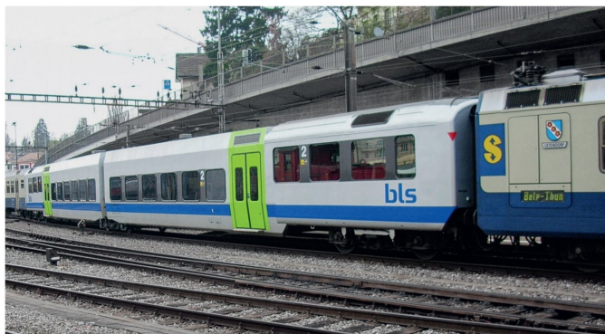
Die Jumbowagen für die S-Bahn Bern entstanden aus ausgedienten EW I-Wagen.
