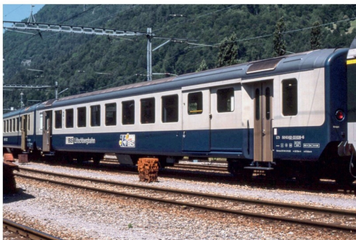
Der BD 839 einer B EW I mit nachträglich eingebautem Gepäckabteil.
