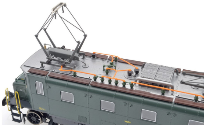
Unter der Druckluftzuleitung des Pantografen befinden sich die Schrauben zum Öffnen der Lok.
