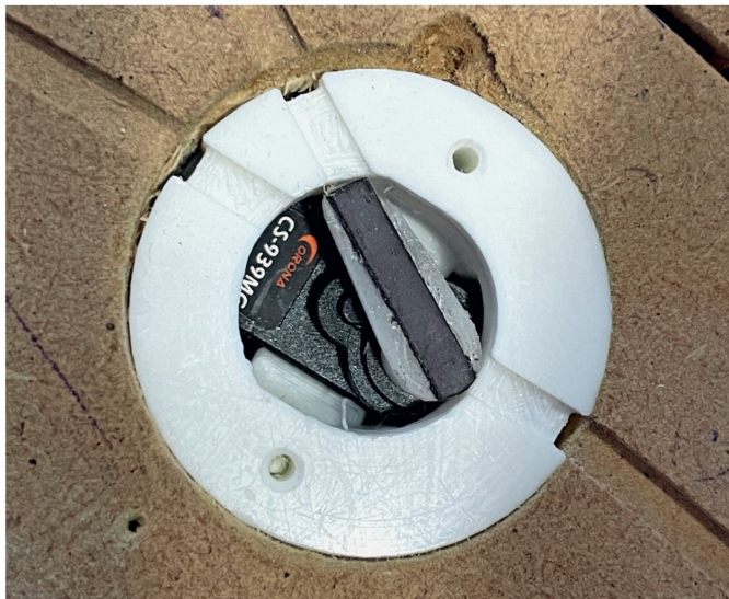
Auch bei Abzweigungen beim Car-System kommen Servos in Unterflurmontage zum Einsatz.
