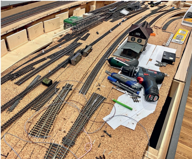
Für die vorbildgerechte Bewegung der Weichen kommen Unterflurservos zum Einsatz.
