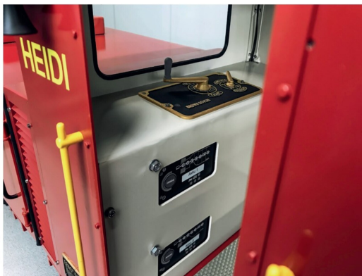
Im Führerhaus kann der Ladezustand der Akkus eingesehen werden.
