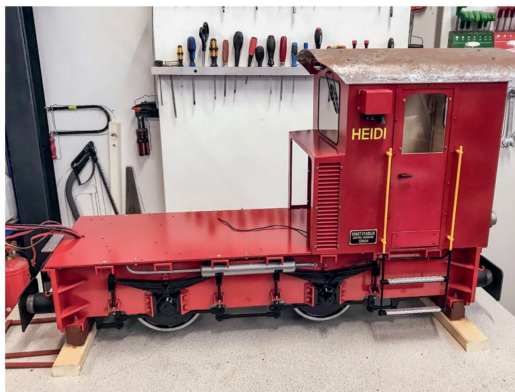
Endmontage: die Heidi mit Führerhaus, aber noch ohne Motorvorbau.
