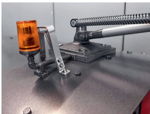
Die Rundumleuchte sowie das Gelenk des Trolley-Stromabnehmers.
