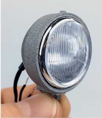
Die Lampen der Heidi wurden durch ein additives Verfahren hergestellt. Der Reflektor stammt aus dem RC-Bedarf.
