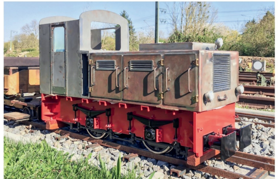
Das erste Mal werden die Motorhaube und das Führerhaus zusammen auf der Lok platziert. Dank einer provisorischen Steuerung ist sie einsetzbar.
