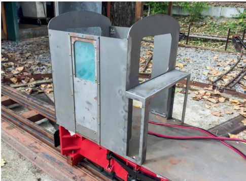
Das Führerhaus wurde ebenfalls aus zahlreichen Laserteilen geschweisst. Für zusätzliche Stabilität sorgen Winkelprofile.
