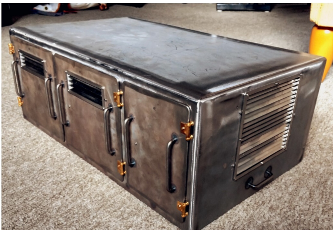
Die Motorhaube besteht ganz aus Stahl und ist mit extra gegossenen Scharnieren ausgestattet.
