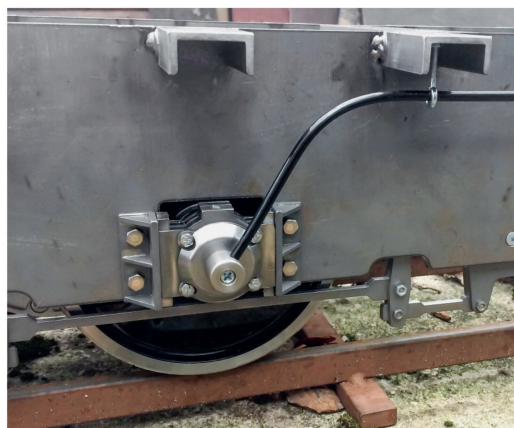
Die Achslagerattrappen bestehen aus einem Stapel von Laserteilen.
