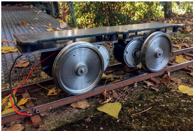
Auf der Vereinsanlage in Karlsruhe wird das Fahrwerk erstmals auf Gleisen getestet.
