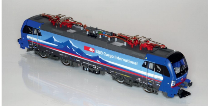
Das neue Modell hat vier verschiedene Pantografen und eine kürzere Kupplungsverbindung.
