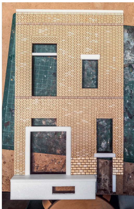
Die Backsteinstruktur ist aus 2 mm dickem Karton ausgelasert.
