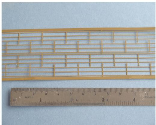
Für die Perronumzäunung verwende ich drei aus Messing geätzte Geländer von 4D Model Shop ([www.modelshop.co.uk](http://www.modelshop.co.uk)), die ich grundiere und danach zweimal mit Acrylfarbe besprühe.
