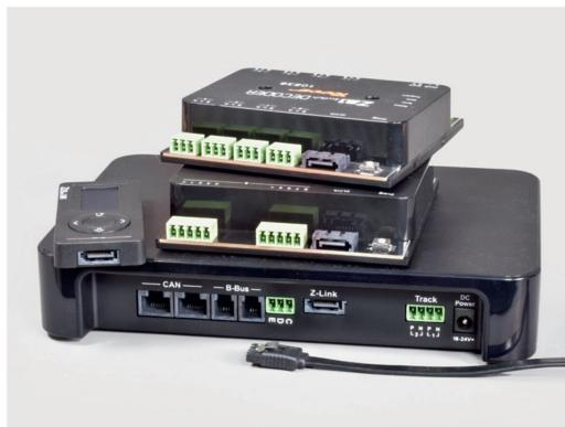
Mit dem Z21 pro Link sind Geräte mit ZLink-Schnittstelle ansteuerbar. Neben den beiden Decodern ist das auch die aktuelle Booster-Generation.
