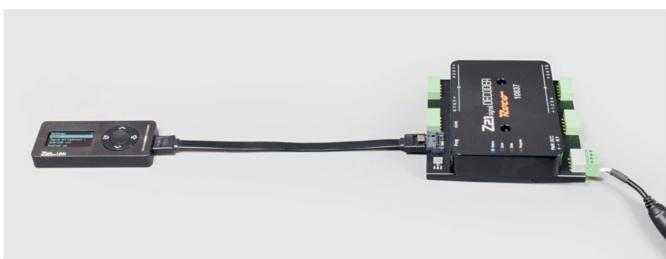
Der Z21 pro Link wird über die ZLink-Schnittstelle angeschlossen und dient nicht nur der Konfiguration. Das System lässt sich auch ohne Zentrale betreiben. Geschaltet wird per Z21-App.
