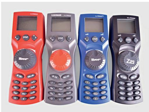
Die rote und die graue Maus sind weitverbreitet. Die multiMausPro ist für die multiZentralePro, die schwarze WLANmaus für aktuelle Z21-Zentralen.
