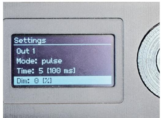
Die Eigenschaften der neuen Roco-Decoder lassen sich komfortabel am pro Link einstellen: Konfiguration des Switch-Decoders mit DCCext.
