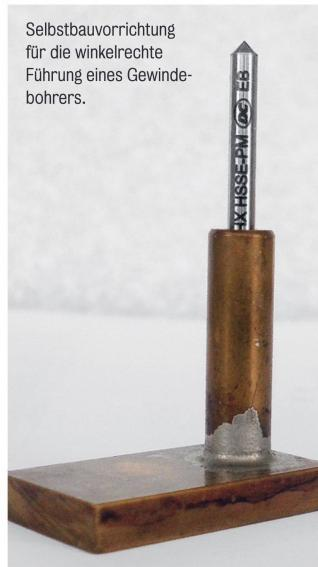
meinen Erfahrungen das reichliche Schmiermittel mit einem Schneideöl, die stete Entleerung der Spannuten des Gewindeschneiders und die korrekte Achsführung des Werkzeuges ohne Verkanten.
