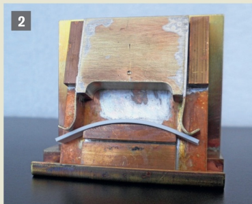
Bild 1: Die Vorrichtung ist fast senkrecht aufgestellt. Ein Polystyrolstreifen wird zwischen der unteren Bogenform und dem beweglichen oberen Gewicht eingespannt. Die Vorrichtung mit dem eingelegten Streifen wird im Heissluftofen auf 105 °C erwärmt.
