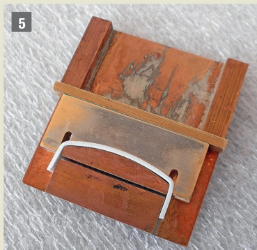
Bild 5: Die Vorrichtung liegt. Das vorgeformte Faltenbalgdach wird mit einer zweiten, oberen Bogenform und dem oberen Querbalken auf die untere Bogenform gedrückt. Derart fixiert wird es bei 120 °C nochmals erwärmt. Temperatur ca. 15 Minuten halten. Anschliessend im abgeschalteten Heissluftofen liegen und langsam erkalten lassen. Nach vollständigem Erkalten werden die unten aus der Form ragenden Teile mit einem massiven Cutter (Tepichmesser) abgeschnitten (untere Nut an der Vorrichtung für Cutterführung).
