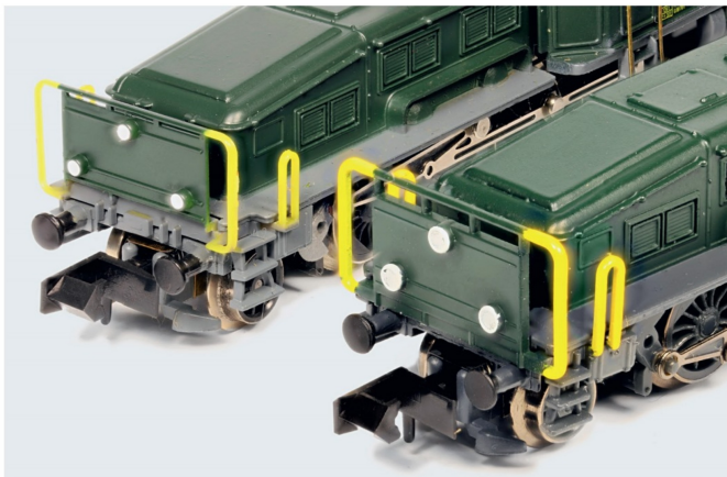
Die Frontbeleuchtung am alten Krokodil (hinten) und an der neuen Version (vorne) im Vergleich.
