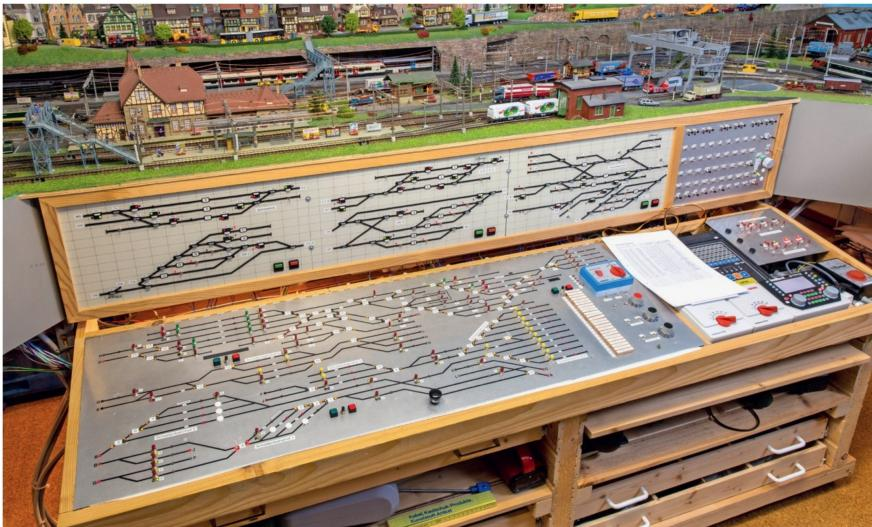
Von hier aus wird die gesamte Modellanlage gesteuert: sämtliche Schattenbahnhöfe, alle Züge und Lokomotiven, die Strecken, Weichen und Signale und natürlich auch die über 50 Effekte. Letzteres erfolgt mit dem kleinen Bedienpult oben rechts.
